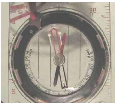
Figure 5 Vis de déclinaison
